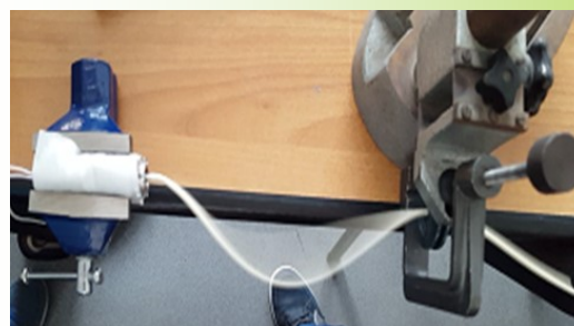
Fig. 3 Prototip ce se mișcă în mediul acvatic cu ajutorul flagelului
